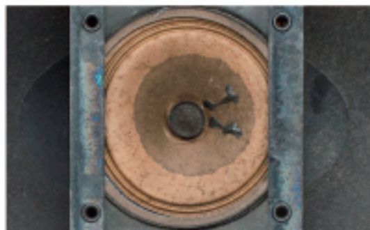
Model-319 内部の写真。同軸タイプのユニット92390-CLのフレームに L / C 型ネットワークが装着されている
