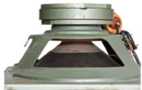
92390-CL 同軸ユニットの正面写真。Model-319 に搭載されているユニットで、フルレンジユニットのエッジ部分はゴム製の素材となっている。これはModel-DSL 529 のユニットも同じである
