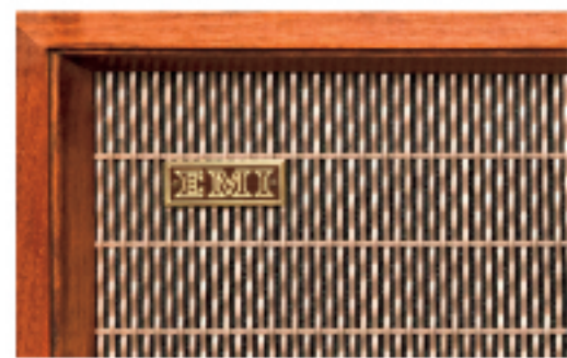
Model-319、Model-DSL 529 のフロントグリル。どちらのモデルも細い金属製のプレートを組み込んだ特注のグリルが採用されており、前面を殆ど金属に覆われていて透過率は40%もないように見えるが、これはユニットの前面に負荷が掛かるアコースティックレンズの役目の機能を果たした構造になっている
