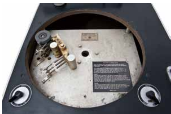
プラッター内部 33、45、78回転用の3個のアイドラーが搭載され、回転をコントロールする
