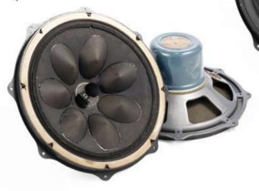
↑このユニットはオルソン博士が38cm口径の同軸2ウェイユニット の1号機として開発したもの。 ウーファーもトゥイーターも磁気回路が 別々の同じコーンタイプのユニットで構成されていることで、音のつな がりが同じ紙素材のため、違和感なく、まるでシングルコーンのような 鳴り方をするのが特徴。強力な磁気回路で固く厚みのあるコーン紙 のウーファーと、極めて薄い紙のコーントゥイーターからは、とてもナチュ ラルでレンジの広いダイナミックな再生音が繰り出される。特にウー ファーの完成度が高く、最近の録音ソースの低音再生にも十分反応 してくれる。とても、60年以上前に開発されたユニットとは思えない ほどだ。市場価格は40~45万円/ペア
