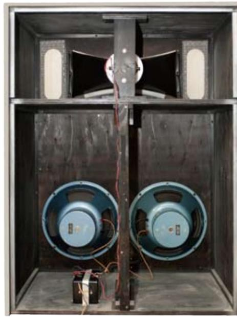
P-63HFのキャビネットは響きの良い米松合板で構成され、その構造は当社が好んで採用しているスリットタイプの低音放射方式になっており、低音は正面ホーンの両サイドのスリットから放出される。そしてH625 10セルホーンを装着したP30ドライバーが内部補強板に載せられている。当時は600Hzの専用ネットワークを使った2wayシステムとして活躍していたが、このシステムに当社の5KTツイーターを追加して3wayシステムとする事でより最新の録音ソースにも対応が可能になる。外観は初期タイプはホーンもすべて同色のハンマートン塗装。後期タイプはホーンが黒塗装で箱はハンマートンに仕上げられている。サイズ 高さ125cm、幅90cm、奥60cm、重量105kg。市場価格は450~500万円ペア
